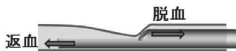
図2 先端部のへばりつき現象発生時の様子 へばりつき現象の定義は、DLCの血流量が血管壁を吸引し0mL/minとなった場合とした。
