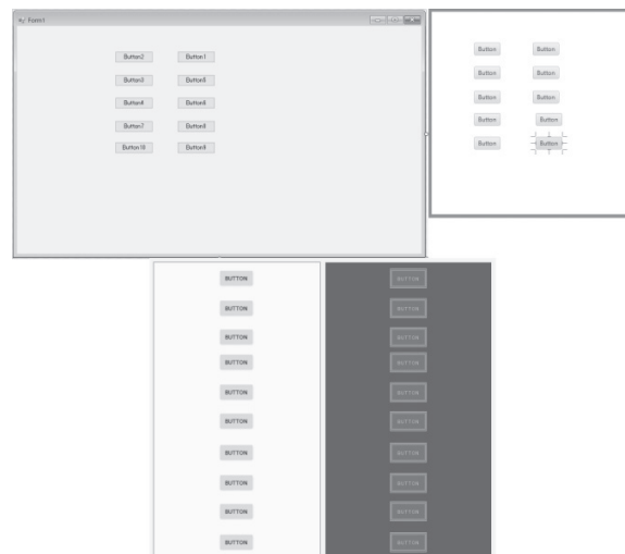
図 1 各統合開発環境上のフォーム設定とボタンコントロールの設置。左上: VisualStudio2017、右上: Eclipse、下: Android Studio
