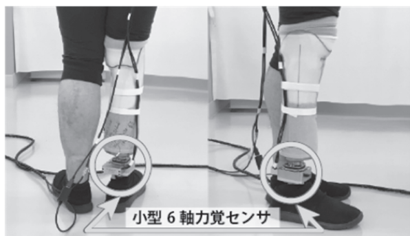
図 1 小型 6 軸力覚センサ設置箇所
